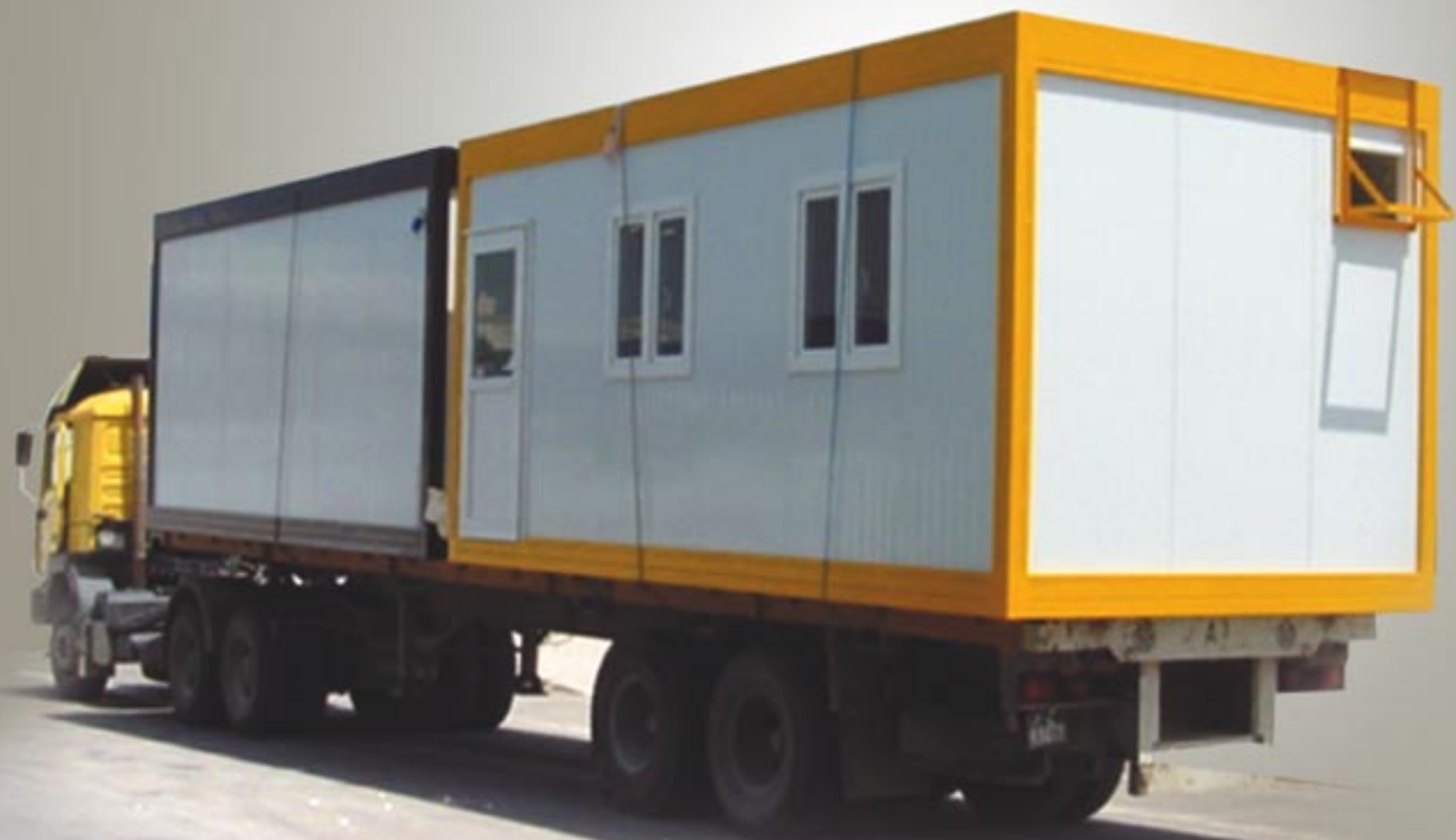
CHARGEMENT ET TRANSPORT 2 MODULES 625
